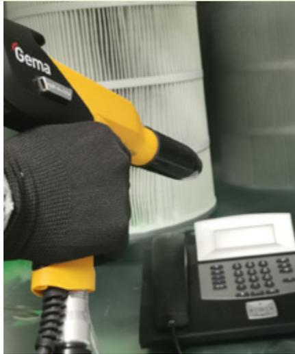
die Kunststoffoberfläche einen so genannten „Primer“ aufzutragen, der elektrisch leitfähig ist. Die ersten Bauteile aus Kunststoff wurden bereits erfolgreich mit dem Pulverlack beschichtet und werden aktuell untersucht. Der Nachweis der antimikrobiellen Wirkung wird für Dezember 2020 erwartet. Die Erkenntnisse aus dem Projekt will das EZD dann auf virusabtötende Kunststoffoberflächen wie z.B. Textilien oder Vliesstoffe für Masken übertragen.
